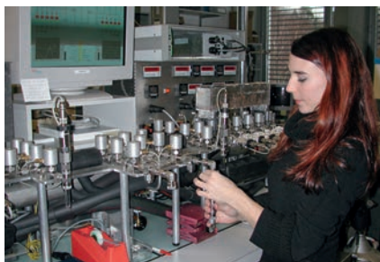
Abb. 7 Im renommierten C14- oder AMS-Labor an der ETH in Zürich werden die meisten Schweizer Proben analysiert. Mit aufwändigen Verfahren werden die Proben gereinigt und für die Analyse vorbereitet.
