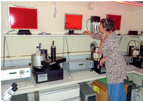
Abb. 8 Dr. Sally Lowick im OSL-Labor des Geologischen Instituts der Universität Bern. Mit den Geräten wurden die Seetaler Sandproben erfolgreich gemessen. Erst diese Methode erlaubt es, Sandproben zu datieren, was ein grosser Fortschritt für die Geologie bedeutet.
